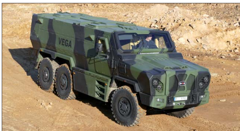
Prototyp vozidla VEGA 6x6 při podnikových zkouškách
