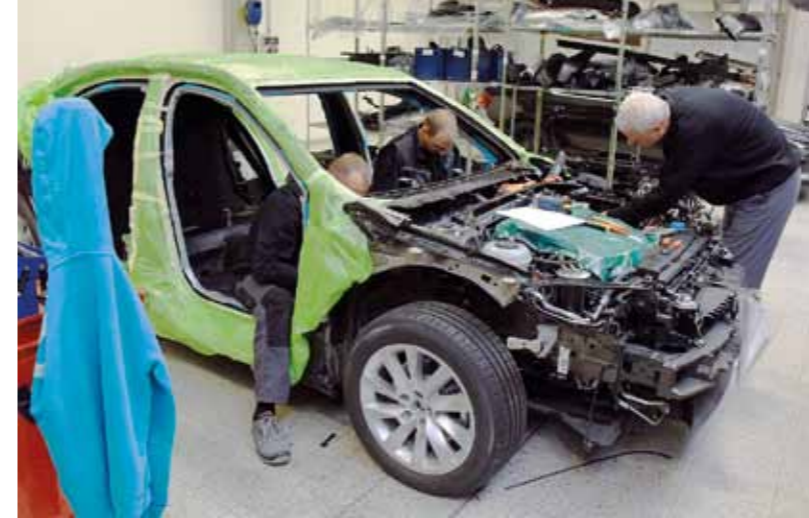
V motorovém prostoru je důraz kladen především na ochranu baterie a řídicí jednotky
