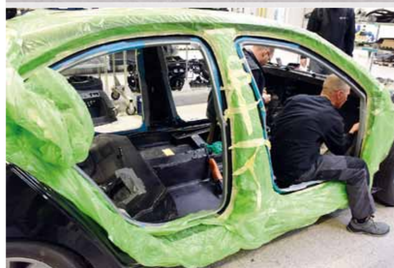
Před přestavbou zůstává pouze holý podvozek. Na něj se následně montuje pancéřová kapsle.
