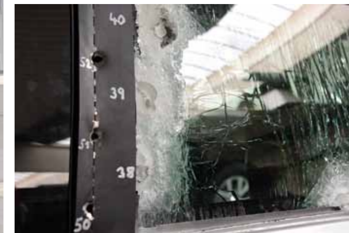
Útočníci většinou volí slabší místa, mezi něž patří třeba spoje. Proto je těmto bodům při zkouškách věnována zvýšená pozornost, respektive více výstřelů.
